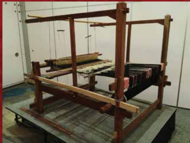
Alat tenun tradisional untuk membuat kain Songket asal Sumatera Barat
